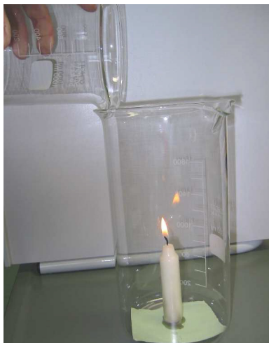
Löschmittel \text{CO}_2 wird eingefüllt
