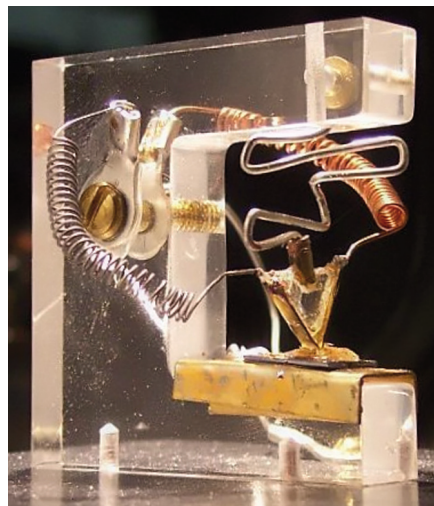
Bild 1: Der erste Transistor von 1947/48. Dies ist ein Foto eines Nachbaus aus dem Nixdorf-Museum.
